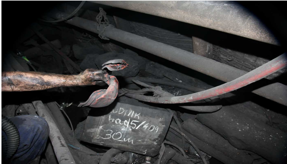
Fot. 10. Nadtopiony wskutek działania płomienia hełm, należący do wyposażenia jednego z pokrzywdzonych przebywających w obrębie „strefy 0”.
