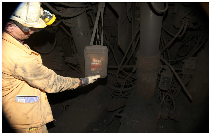
Fot. 14. Aparat uciezkowy typu SR-60 o numerze 33513 pozostawiony na stanowisku pracy w polu roboczym ściany wydobywczej, pomiędzy sekcją obudowy zmechanizowanej numer 150 i 151 (końcowy odcinek ściany). Stan i lokalizacja aparatu wskazują, iż pokrzywdzony pozostawił go przed zdarzeniem.
