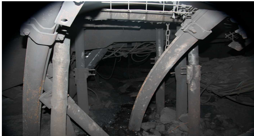
Fot. 7. Wlot do zaliczonej do „strefy 0” ściany 5/409. Niedaleko od miejsca widocznego na zdjęciu znajdowało się zlokalizowane w toku oględzin miejsce zainicjowania wtórnego wybuchu mieszaniny hybridowej metanu i pyłu węglowego.
